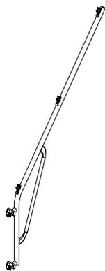
Tubo con dos abrazaderas, para la sujeción en el marco, y tres ensambles, para colocación de los tirantes.
