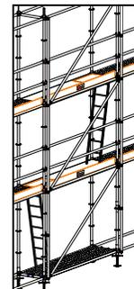
La colocación de estos soportes se realizará cada 1 m en altura.
