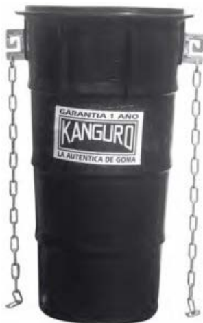
Bajante tramo recto Rubber standard section Cadena DIN 763 Ø 7mm Largo 1.1 m – espesor 10mm
